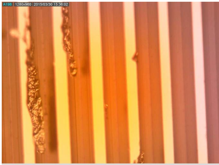
Obrázek 4: Nedolisy na desce [2]
